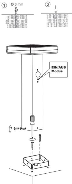
Die Solarleuchte muss über die drei Öffnungen am Standfuß auf einer glatten, ebenen Fläche festgeschraubt werden (siehe Bild 1 + 2). Eine Montage über einen Erdspiß macht auf Grund der Höhe der Leuchte keinen Sinn. Diese würde bei Wind umkippen und evtl. Schaden nehmen.
