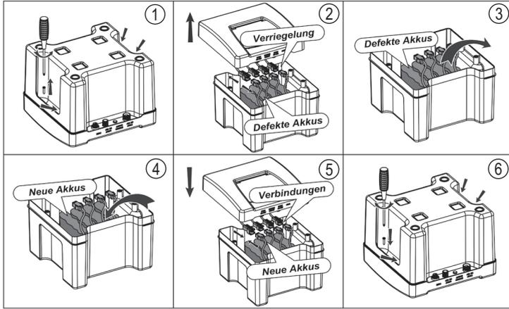
1. Bild 1+2: Schalten Sie den Akkuspeicher aus und stecken Sie alle angeschlossenen Kabel (Solarpanel, Solarpumpe, LED-Lichtring) ab. Lösen Sie die 4 Schrauben des Gehäuses und nehmen Sie den Deckel ab.
