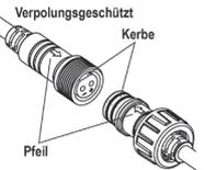
Die beiden Solarmodule werden mit dem beiliegenden Y-Kabel verbunden (siehe Bild rechts). Verbinden Sie die beiden Steckverbindungen des beiliegenden Y-Kabels mit dem der Solarmodule.
