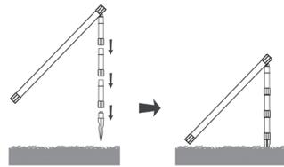
Die Solarmodule können hoch oder quer montiert werden. Je nach Montageart müssen mehr oder weniger Verlängerungsrohre verwendet werden. Stecken Sie die Halterung auf den Alurahmen der Solarmodule auf. Verwenden Sie nun die Verlängerungsrohre und den Erdspieß um das Modul aufzustellen und zu fixieren.
